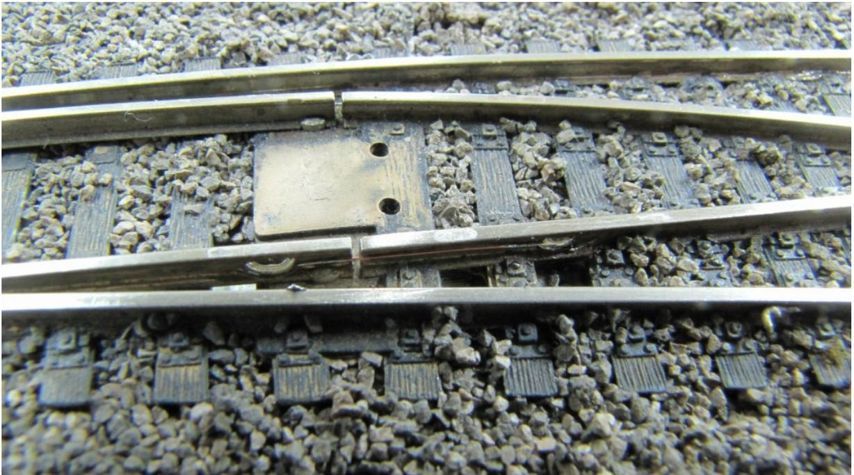
Como se puede ver, el cable está soldado en la parte exterior del carril para evitar problemas de rodadura, y además lejano de la zona de paso del carril desviado por la misma razón. En este caso el espadín para soldar tendría que estar en la posición desviado (hacia arriba) para que el cable no tense el movimiento del espadín.
