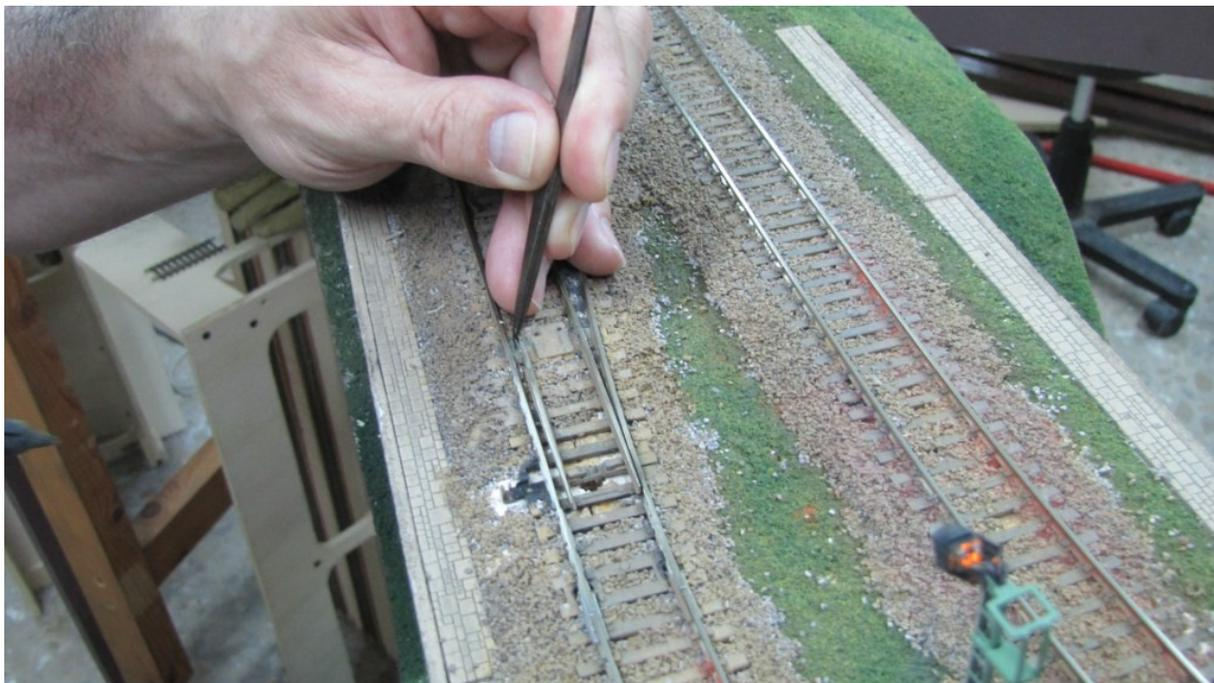
A continuación se estira el cable hacia el carril dónde se soldará por segunda vez con las pinzas y se repite la operación, ahora las pinzas están tirando de un extremo y la soldadura se hace justo al lado.
