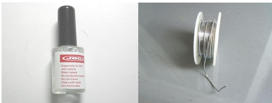
Flux para hacer más rápida la soldadura. En este caso el flux que utilizamos fue uno de JBC con base de agua, el cual no oxida la parte de los metales a los que no llega soldadura.
