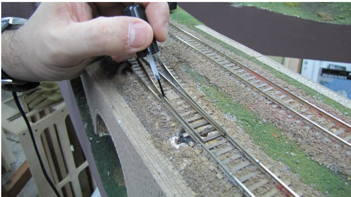
Como es un flux que no contiene alcohol, no se evapora si no se calienta, y además los componentes están preparados para no reaccionar químicamente, lo que evitará la posterior oxidación de partes que no se suelden.
