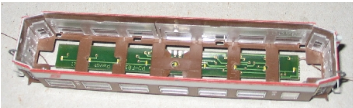
Figura 4. Los puntos amarillos son los leds. Para poder poner la tira de leds he tenido que hacer unas modificaciones.
