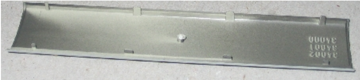
Figura 9: El techo se une al bastidor con 4 engarces por cada testero.
