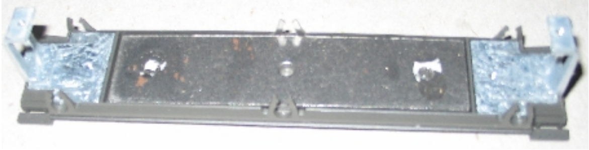
Figura 3. En esta imagen se ve claramente que las dos piezas laterales están separadas del contrapeso central.
