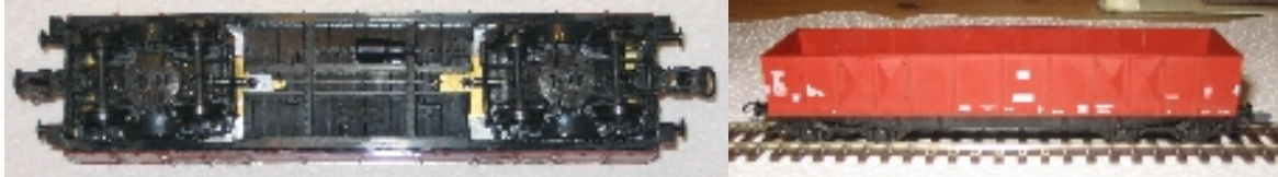
Figura 15: En este vagón tuve que rebajar 3 mm de suelo para que los topes coincidieran a la altura recomendada.
