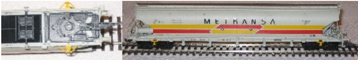
Figura 14: Vagón de cereales con chasis de plástico. En el chasis de plástico es más fácil trabajar.
