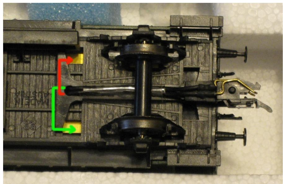
Para sujetar los cables incluso un poco de cinta adhesiva es suficiente para pegarlos a la pieza del enganche corto. El agujero que se ve en la foto es el enganche del muelle para hacer que el enganche vuelva a su sitio.
