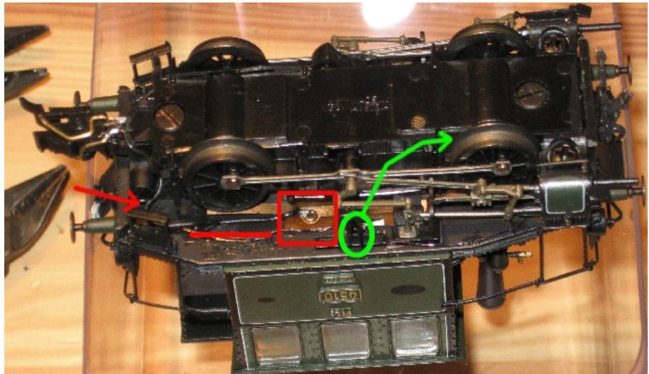
Se procede de igual manera con el otro cable y ya está montado el enganche. El único requisito para terminar es poner algo de pegamiento de cianocrilato en la hendidura del chasis por la que escondemos el cable, y que está marcado con la línea roja en la imagen de arriba. Una vez que tenemos la locomotora ya finalizada comenzaremos a hacer lo mismo con el vagón que le acompaña, un furgón, en el cual los cables no se han cambiado por más pequeños por no ser necesario.
