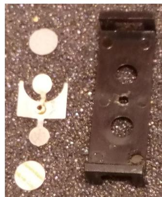
Como se puede ver, a la izquierda la pieza montada, a la derecha ya desmontada de la que sólo utilizaremos el plástico para volver a sujetar las bombillas al chasis.
