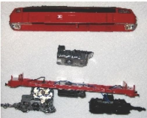
Esta locomotora tiene en los extremos una especie de "flechas" que sujetan bastidor y carrocería, se han de separar con mucho cuidado para no romper la pieza de plástico que sujeta los faros (de color gris).
