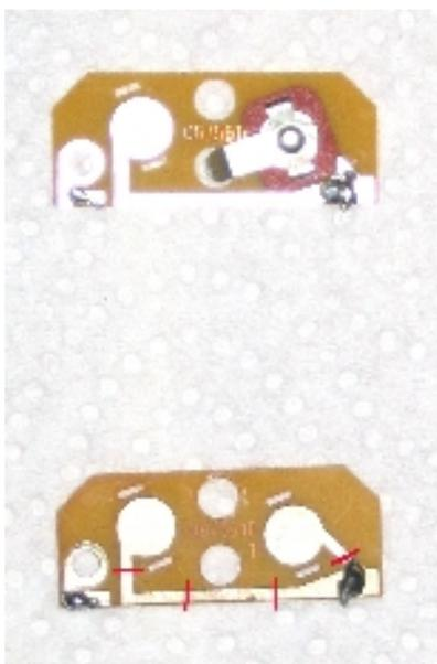
En la foto de la izquierda se puede ver la misma placa con sus componentes o despojada de los mismos. Con líneas rojas he marcado los lugares dónde se tienen que cortar las pistas para poder soldar posteriormente los led.
