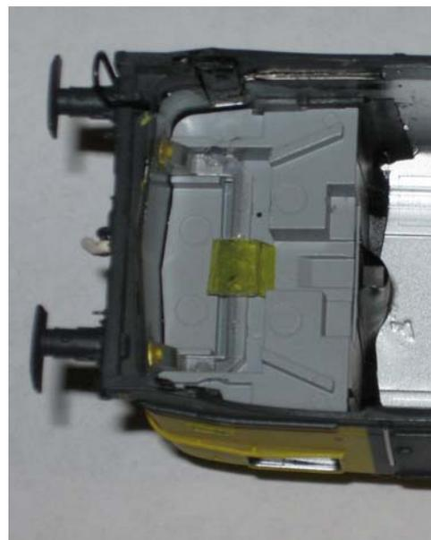
En la foto de la izquierda, debido a la poca luz sólo se observa el led de color amarillento, la lámina está insertada entre éste y el chasis. En la foto de la derecha vemos como se ha pegado la pieza postiza sobre los tubos de fibra que trasladan la luz a los faros.
