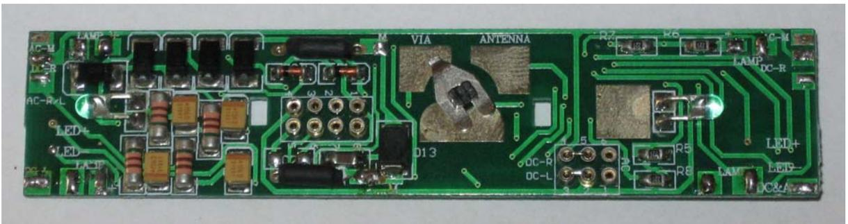
En el lado inferior se tienen que quitar el condensador amarillo, el condensador electrolítico de filtro, el 7530-1 (3 patas) y el puente rectificador (es importante quitarlo para que se aíslen los contactos con la corriente directa de la vía). La placa quedará totalmente limpia de componentes.
