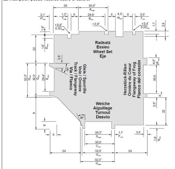
Tolerancias del calibre: + significa +0,03 / -0 - significa +0 / -0,03 Tolerancia de las cotas libres 0,5
