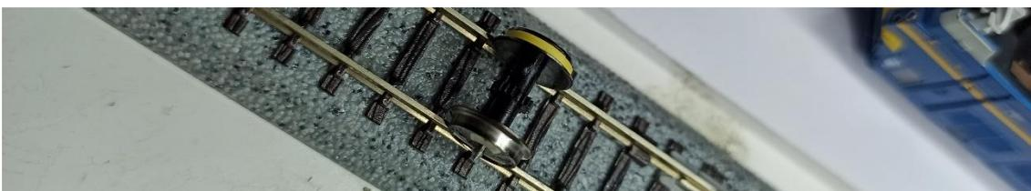
Una vez dentro viene lo que en teoría para mí es más difícil, se tiene que acercar algún tipo de calor (punta de soldador), llama de mechero o secador de pelo para que al calentar mínimamente la banda ésta se ajuste a la rueda como un guante.
