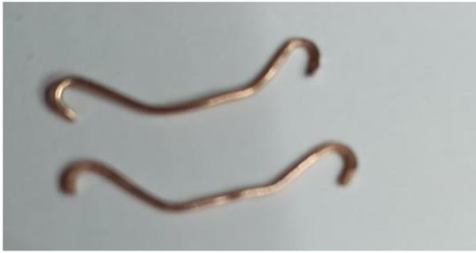
Las dos piezas de alambre de cobre preparadas en las que uno de los extremos abraza mejor al eje y el otro extremo queda algo más suelto para que puedan entrar los ejes en el bogie. Las dos piezas deben entrar por la parte exterior de los ejes, poniendo primero la parte más cerrada.
