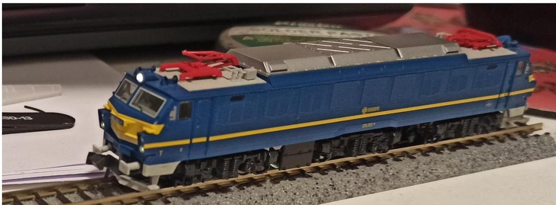
Antes de poner la locomotora en la vía hay que medir la continuidad entre las ruedas intermedias y las ruedas del mismo lado de los bogies motores. Y sólo cuando estemos seguros de que está todo correcto se pueden hacer las pruebas de marcha. En el caso de que se hayan puesto los cables al revés nos va a hacer cortocircuito seguro, y en el material de N digital es muy delicado que haya un cortocircuito permanente que podría fundir los soportes de las ruedas o los bogies de plástico.
