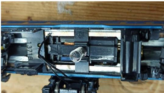
Una vez que hemos detectado dónde va cada cable soldado, con un punto de soldadura se pegan a las tiras de contacto del chasis. Aquí no he calentado apenas las tiras para evitar que el plástico que hay por detrás se fundiera. La mejor manera es poner una gota de flux y acercar el soldador para que “caiga” sobre la lámina.
