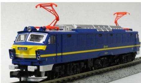
El modelo de Kato 137-1331, importado por Soldat hace ya mucho tiempo, lleva los dos bogies motorizados y el bogie central totalmente libre, que bascula y gira sobre un eje central y un muelle que lo mantiene pegado a la vía. El desplazamiento lateral del bogie es correcto y el giro se produce sin problemas.
