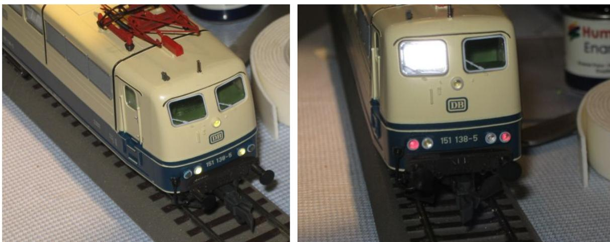
En el caso que se realice el montaje de las luces rojas en circuito aparte, también se tendrá que incidir en la CV de la función C, ya que al apagar los faros blanco se iluminarán más fuertemente los leds rojos. Para seguir con más detalle el montaje de la función se puede seguir el artículo que hice de la BR218.
