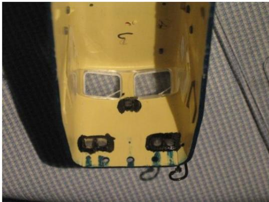
Una vez introducidos los pivotes de metacrilato en los agujeros de los faros queda de la manera que se ve en la foto. Se pueden enrasar volviendo a limarlos un poco. Si los limamos o lijamos con un grano muy fino no será necesario bruñir la parte interior del pivote para que luzca con claridad.
