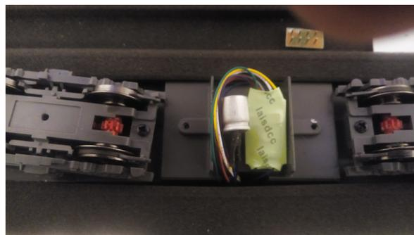
Para desmontar los bajos de la locomotora hay dos tornillos que juntan la pieza de plástico al chasis, del tipo philips. Hay que tener en cuenta que en esta locomotora el decodificador y/o altavoz van a ir alojados en la parte inferior del chasis, como se puede ver en la fotografía. Por uno de los laterales de la locomotora se puede ver que hay una acanaladura para los cables, que suben hasta la placa principal dónde está el conector de 8 pines.
