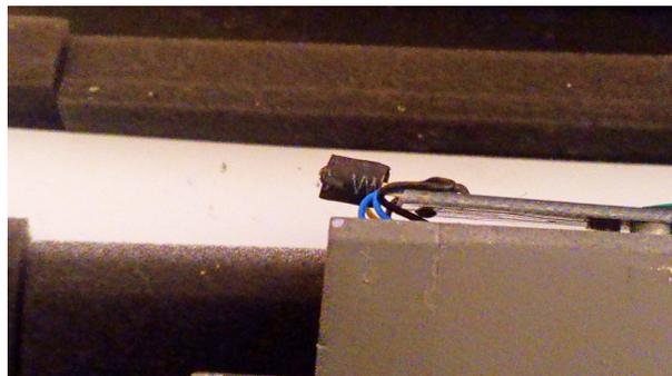
En la foto se puede apreciar como queda el led con su carcasa de material termosensible. Hay que recordar que si se aprietan mucho los tornillos de sujeción de la placa, al tener el punto de apoyo algo alejado del tornillo, se suele arquear (como se ve en la figura), y ésto, unido al leve giro hacia arriba del led nos da una luz directa sobre el reflector del faro superior.
