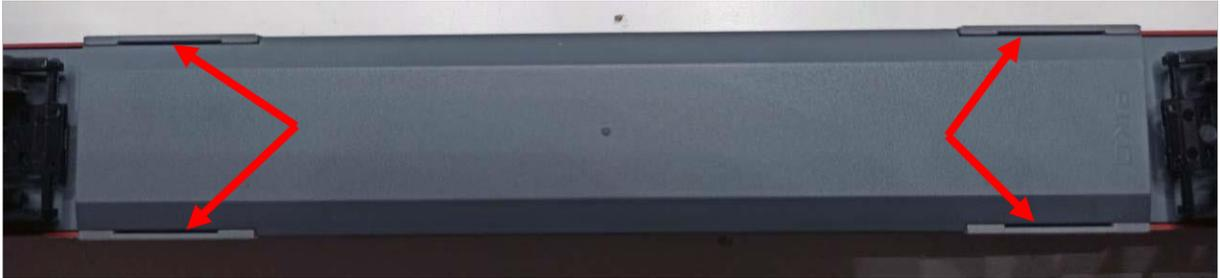
Se desliza la tarjeta y se hace un poco de presión en forma de palanca mientras se abre hacia los lados la carrocería. Para ver mejor dónde se encuentran los encajes pongo esta imagen:
