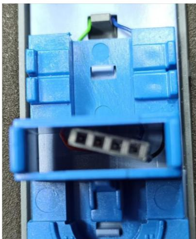
En la parte inferior se pone el terminal hembra soldado a los cables que vienen de la vía y que se esconden en la trampilla interior.
