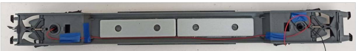
Una vez desmontado el chasis, se desmontan también los bogies del mismo, el motivo será poder montar unas pletinas de rozamiento en el eje de TrainOmatic. Para hacer esto que se ve en la foto he desmontado el cable que viene de serie y dejado plana la soldadura para taladrar la platina de cobre, de esta manera se inscribe mejor en el bogie y además sirve también de tope de inmovilización.
