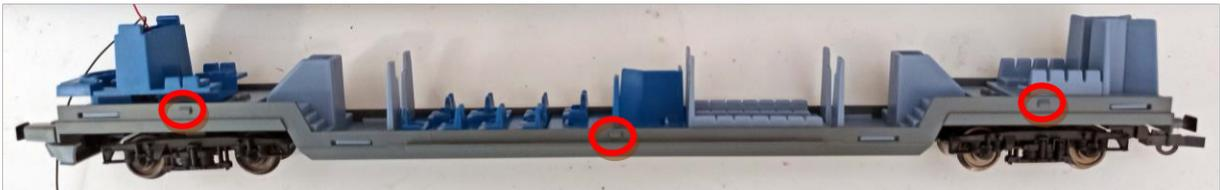
Debajo de la puerta de intercomunicación tiene otro encaje (esta vez la carrocería) que es muy fino y se puede salvar desplazando la carrocería hacia adelante.
