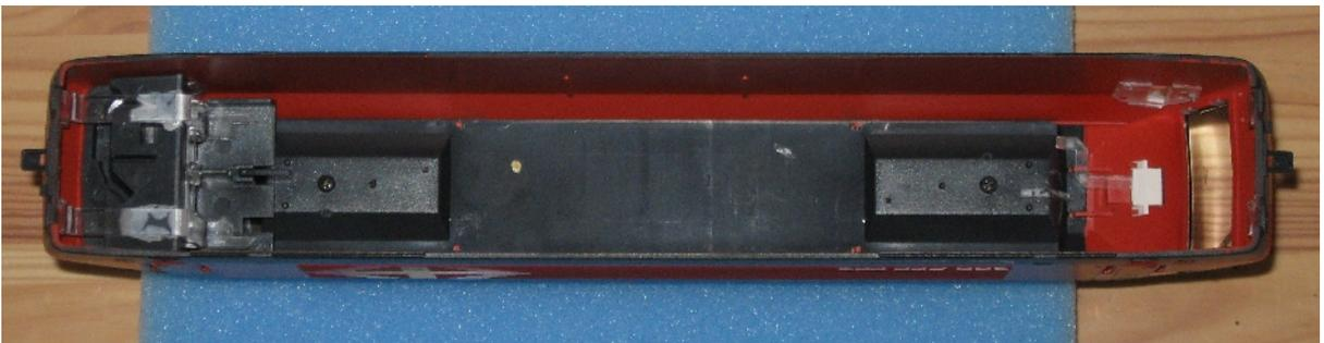
Una vez terminada la carrocería queda de esta manera, y sobran dos piezas, una de ellas puede servir para poner en una locomotora que no tenga cabina...
