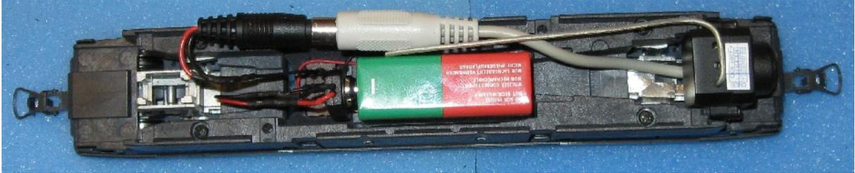
De esta manera, una vez puesto todo en su sitio evitaremos tener que desmontar la carrocería cada vez que tengamos que cambiar la pila, ya que al ser recargable se puede recargar por el enchufe, y además, cuando no esté en funcionamiento puede estar totalmente aislada del circuito y así no gastar batería inutilmente.
