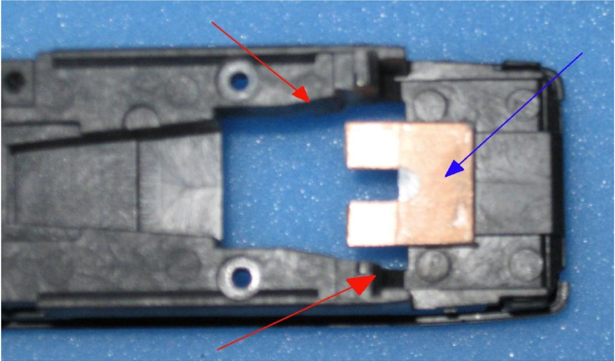
En la foto se muestra la salida de motor ancha, y en ella las partes que se tienen que mecanizar. La primera, la flecha roja de arriba es que se tiene que agrandar la boca del chasis lo ancho de la parte trasera de la cámara, y serán aproximadamente un milímetro de profundo por unos 5 milímetros de largo.
