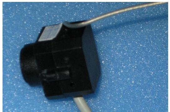
El cometido de los tornillos largos o el mecanizado de la cámara es la sujeción de la misma al chasis por la parte posterior de la cámara.
