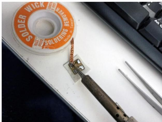
Es especialmente útil para retirar rápidamente el estaño en aquellos pads de soldadura de elementos SMD que quedan abombados y no nos permiten poner el LED o resistencia SMD en su sitio, y menos sujetarlo contra la placa.
