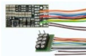
Como se puede ver se utilizan los 8 cables de la norma NEM 652, y el verde se utilizará para iluminar las matrículas. El descodificador tiene además pads suplementarios para SUSI, AUX2, AUX3 y AUX4.
