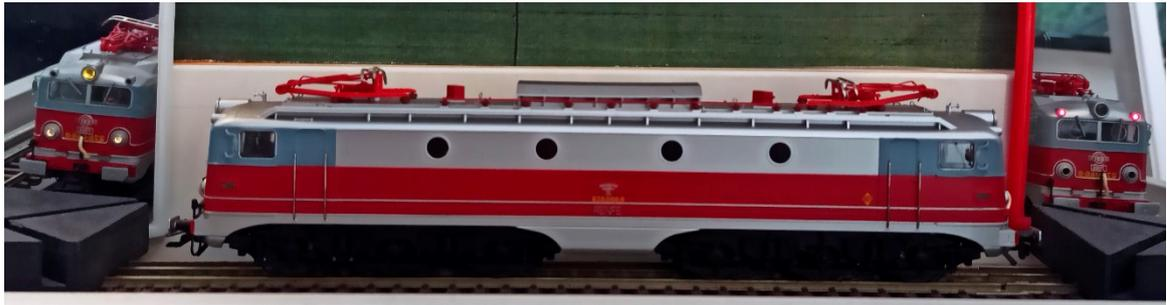
Tenemos para cada testero cuatro posibilidades diferentes de iluminación, además del testero totalmente apagado con una función.
