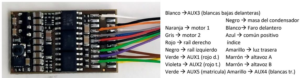
Debajo del descodificador he realizado una placa de soporte del mismo con pistas longitudinales que llevan sólo los cables a las conexiones de vía (rojo y negro). De la placa suelta no hice foto. Las dos pistas laterales tienen soldados el cable del descodificador correspondiente y la conexión del bobie delantero correspondiente. Para darle más solidez soldé un par de alambres con la placa.
