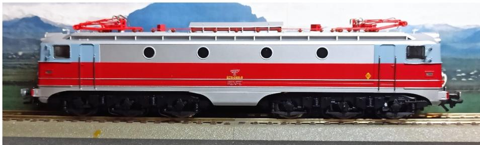
Para mí hay dos tipos claramente diferenciados, las de pantógrafo simple que en teoría sufrieron modificaciones interiores y constituyen la serie de sonido 2 de Carlos Nuñez y las originales de Alstom que llevaban el pantógrafo antiguo de doble brazo.
