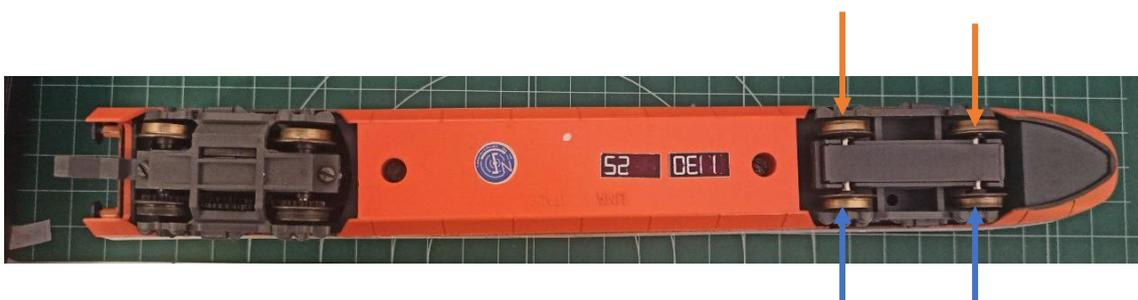
Independientemente de que se retiren o no las tomas de corriente del bogie trasero, al tener el primer bogie tomas de corriente en ambos carriles, sólo por esto se evitará que esta motriz se quede parada.
