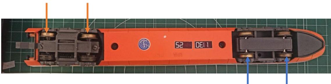
La solución más fácil será poner una toma de corriente en las ruedas del primer bogie debido a que el bogie motor tiene aros de adherencia, como se ve en la siguiente foto.
