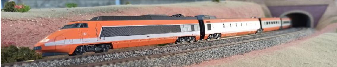
El motivo por el cual se paraba entre dos amplificadores distintos es porque todo el material antiguo de Lima tiene las tomas de corriente en el primer bogie en un lado y en bogie motor (segundo bogie) en el otro lado.
