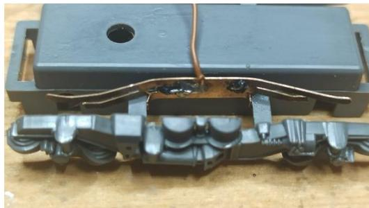
La pletina superior es la original que yo he recortado para que pueda caber en el bogie, como se muestra en la foto de la derecha. Sujeto la pletina con un cable soldado. El cable está con su aislante para evitar que toque el frotador del eje que es el otro polo.
