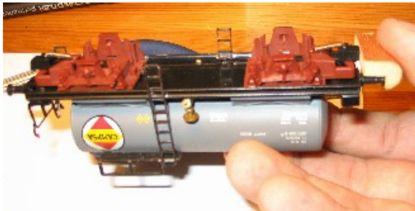
Figura 8: Otras veces tenemos que posicionar el soporte de tal manera que quede a la medida para tocar "tope con tope", para ello utilizamos un perfil de madera con las medidas NEM.
