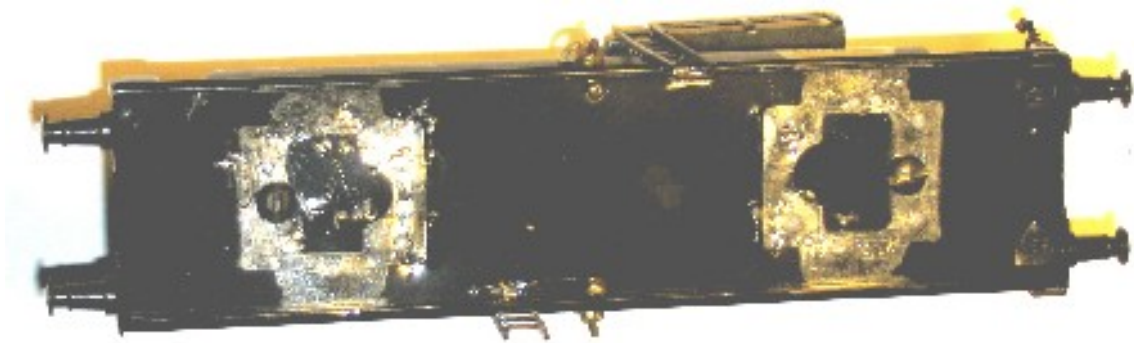
Figura 4: En esta foto se puede ver la “sombra” de dónde estaban los soportes de los ejes, y el vagón preparado para la pintura y posterior pegado de los ejes nuevos (por eso está ya montado el bastidor con sus correspondientes tornillos).
