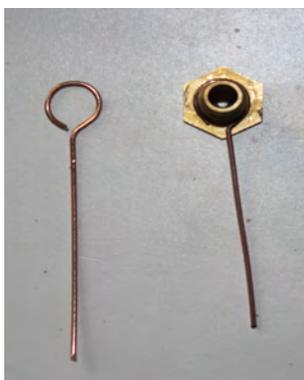
Posteriormente pensé en que al no tener la placa del automotor una pieza de contacto para las escobillas, tendría o bien que buscar una o bien fabricar una (posteriormente fueron dos). Pensé en dos nuevos contactos de las escobillas, que fabricados con hilo de acero esmaltado quedaron de la forma que se ve en la foto siguiente, pero en vez de solidarios a la placa de la locomotora lo estuvieran con el motor.
