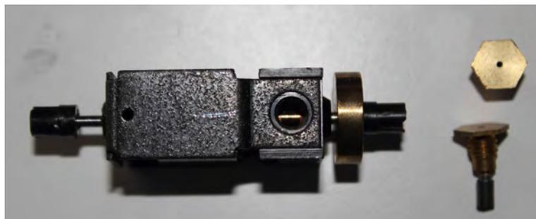
En esta tercera imagen se puede observar que hay una pieza plástica que aísla el cuerpo de las escobillas, y además es su soporte porque en ella van enroscados los tornillos que las albergan.
