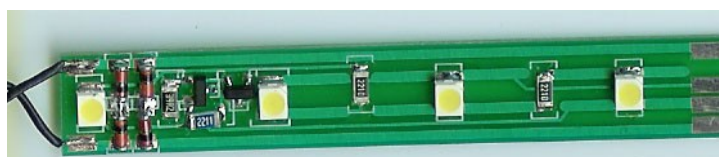
Fotografía del conjunto indivisible formado por regulador y 4 leds.
