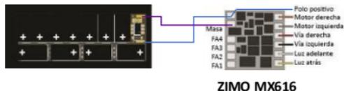
En el almacenamiento de energía de la locomotora hay un lado equipado con 2 pads dorados. El pad de masa está etiquetado con «-». El pad del polo positivo está etiquetado con un pequeño «+». Estos dos pads se conectan al descodificador de la locomotora. Preste atención a la polaridad correcta cuando los conecte al descodificador de la locomotora.
