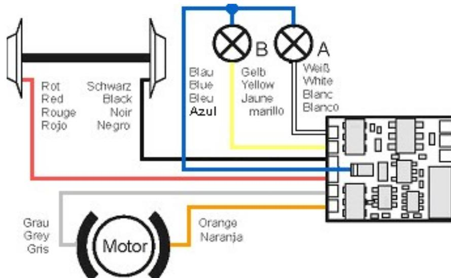
**Figura 1: Conexión del descodificador GOLD con cables**
