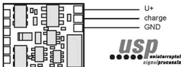
El descodificador tiene bornes para soldar para la conexión del módulo acumulador (por ejemplo el POWER 1). Vea sobre el particular la figura de encima. Suelde los cables correspondientes del acumulador a los bornes del descodificador. En los trabajos de soldadura no cruce los bornes (corto-circuito) entre ellos o con otros contactos.
