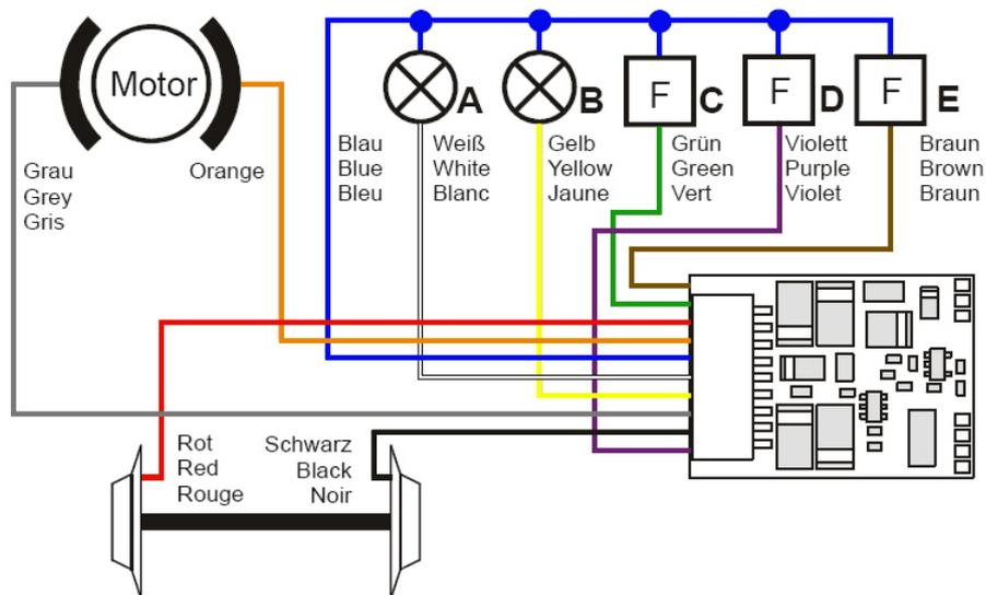
Figura 1: Conexión del descodificador GOLD+/SILVER+ con cables
