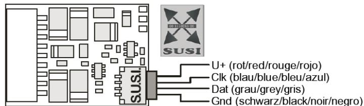
Los colores de los cables respetan igualmente estas especificaciones. Enchufe prudentemente la toma macho de su módulo S.U.S.I. en el conector hembra del descodificador. Esta toma macho sólo puede insertarse en un solo sentido.
