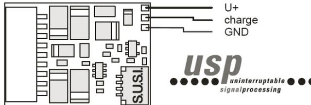
El descodificador lleva unos bornes para soldar para la conexión del módulo acumulador (por ejemplo el módulo POWER 1). Vea la figura de encima. En los trabajos de soldadura cuide con no establecer ningún enlace eléctrico entre los bornes o con otros contactos.
