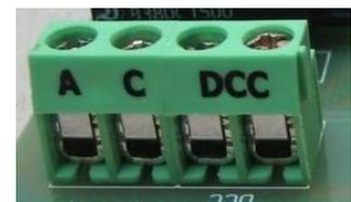
**Conexión de la corriente digital:** Conecte los bornes DCC a la salida de corriente digital del booster o amplificador, (en el caso de Lenz J y K).
