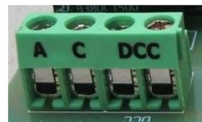
**Conexión de la corriente digital:** Conecte los bornes DCC a la salida de corriente digital del booster o amplificador, (en el caso de Lenz J y K).
